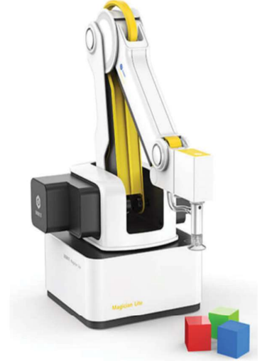
Figur 1 Dobot Magician Lite – en stationær miniature industrirobot med præcis motorstyring. Robotten ses her monteret med hhv. gribeklo og sugekop.
